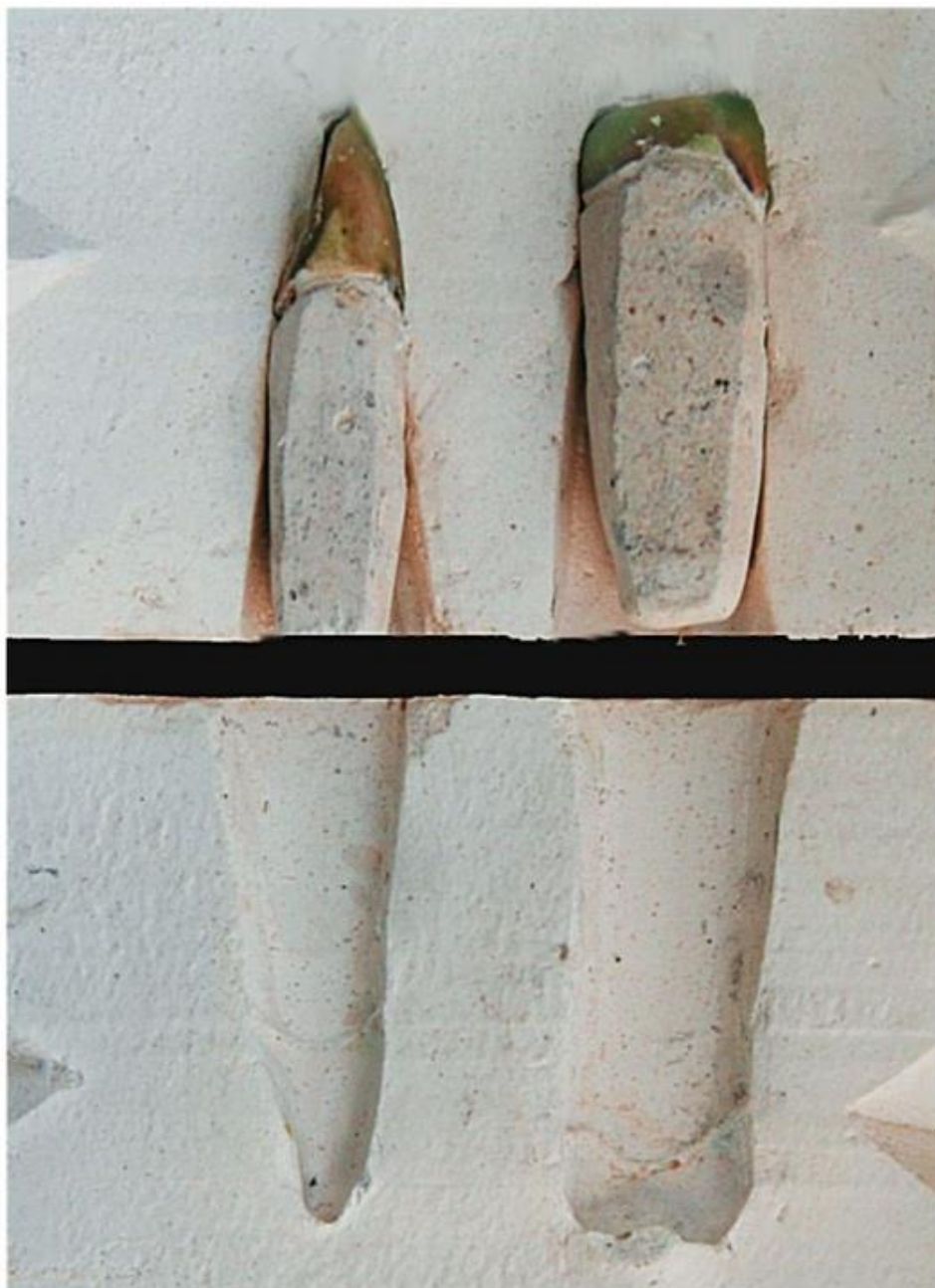
Рис. 14.15. Раскрытый гипсовый блок для получения нескольких штампов из легкоплавкого сплава
