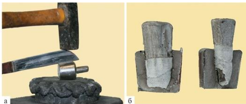
Рис. 14.24. Получение металлических контрштампов для комбинированного метода штампования (а, б)
