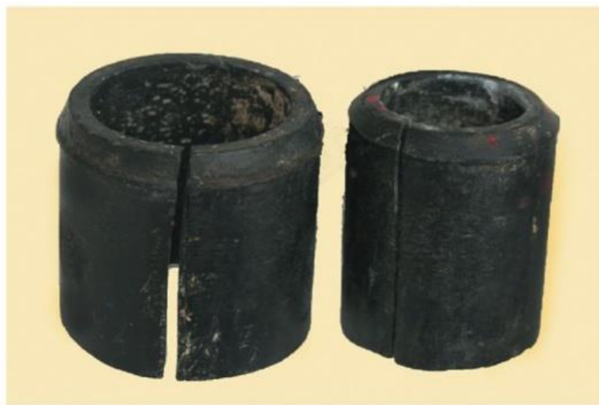
Рис. 14.9. Резиновые кольца для воспроизведения гипсового штампа в гипсовой форме из легкоплавкого сплава
