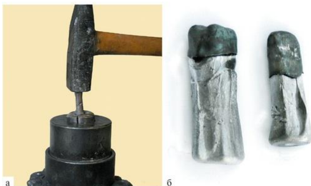
Рис. 14.25. Установка контрштампа с металлической коронкой на штампе и окончательное штампование (а); коронки на металлических штампах после окончательного штампования (б)
