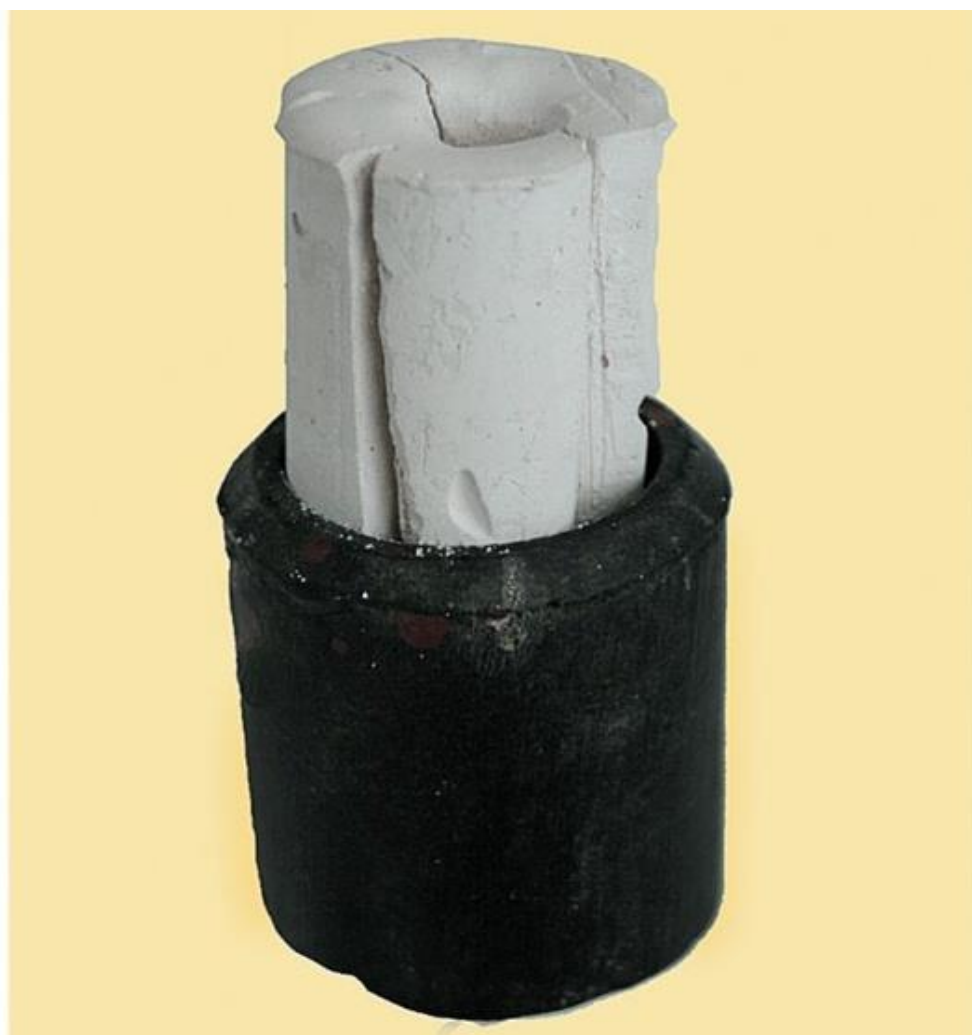
Рис. 14.11. Собранная гипсовая форма для получения штампа из легкоплавкого сплава, помещённая в резиновое кольцо
