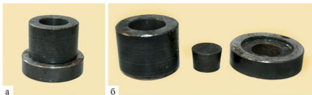
Рис. 14.22. Модификация аппарата для комбинированного метода штампования в сборе (а) и в разобранном виде (б)
