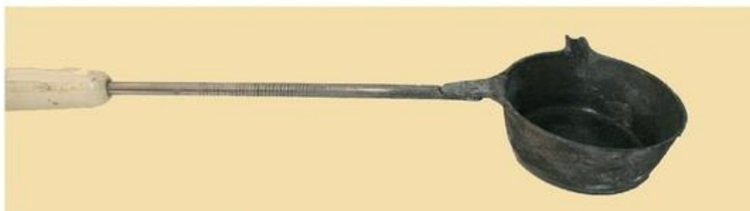
Рис. 14.12. Металлическая ложка для расплавления легкоплавкого сплава
