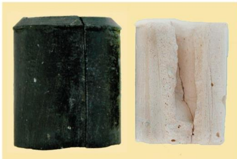
Рис. 14.10. Расколотая гипсовая форма для получения штампа из легкоплавкого сплава
