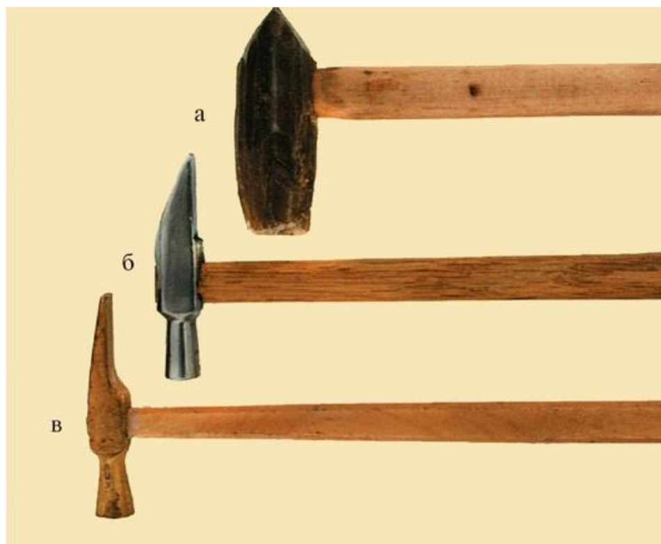
Рис. 14.17. Зуботехнические молоточки: а - роговой молоточек для изготовления коронок из драгметалла; б - стальной молоточек для изготовления коронок из нержавеющей стали; в - латунный молоток для работы с драгметаллами
