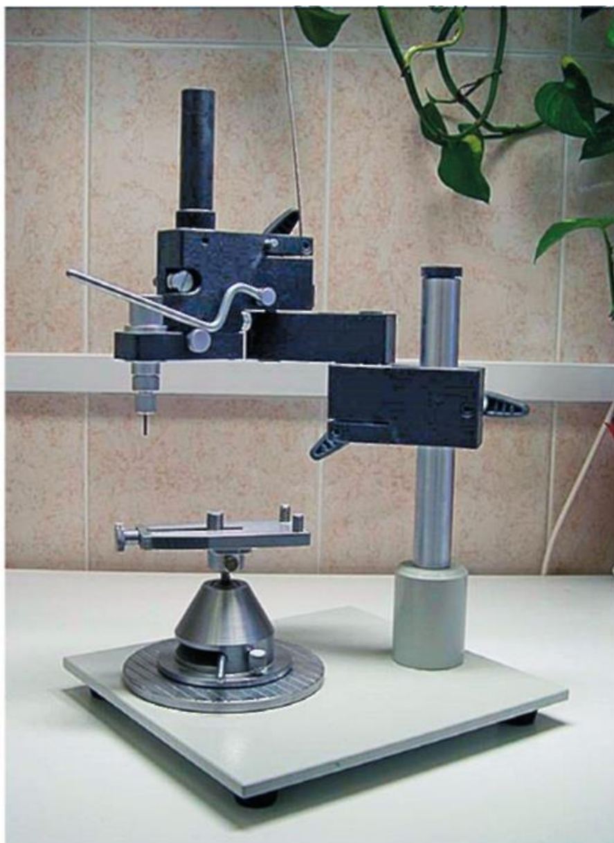
Рис. 2.6. Фрезерно-параллелометрическое устройство отечественного производства (ФПУ 1.0)
