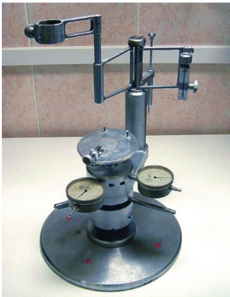
Рис. 2.5. Координатный параллелометр (разработан Л.М. Гладких, В.С. Погодиным, В.П. Чувашевым; а.с. СССР № 324031)
