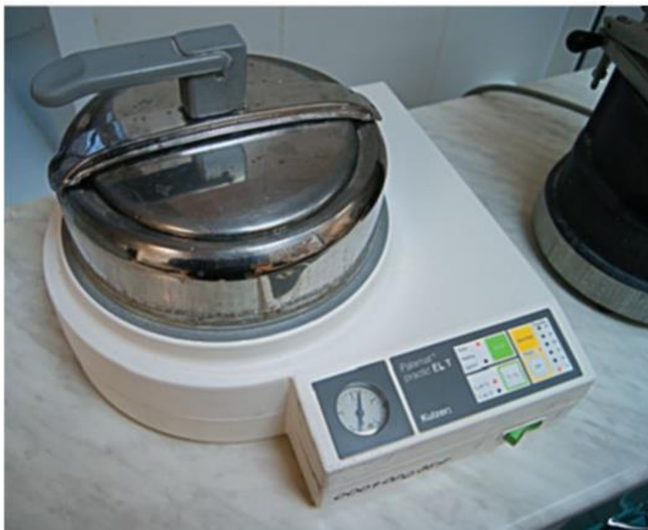
Рис. 2.100. Аппарат для низкотемпературной полимеризации пластмасс
