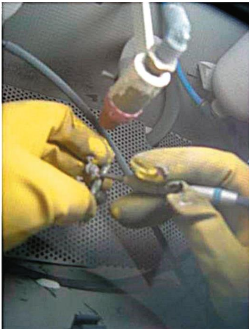
Рис. 2.93. Пескоструйная обработка каркаса дугового протеза
