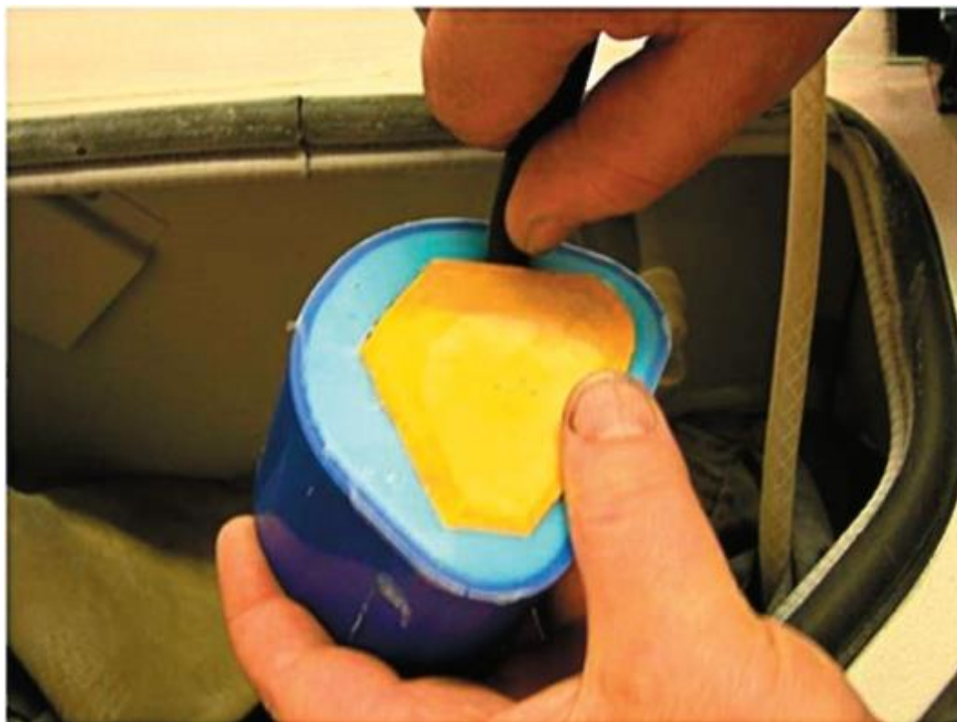
Рис. 2.83. Извлечение гипсовой модели из силикона
