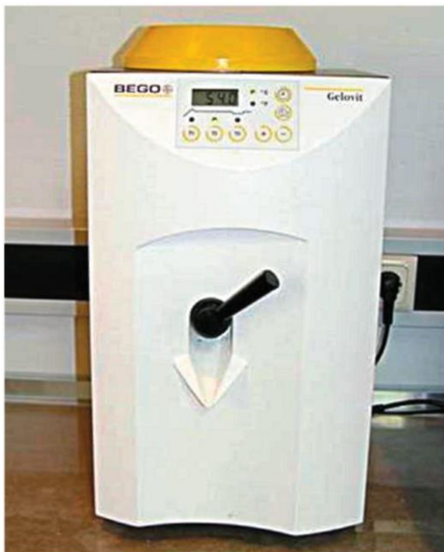
Рис. 2.80. Аппарат для разогрева гидроколлоидной массы
