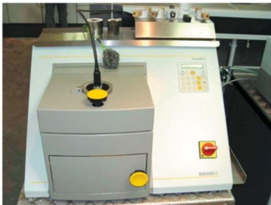
Рис. 2.92. Вакуумная литейная установка
