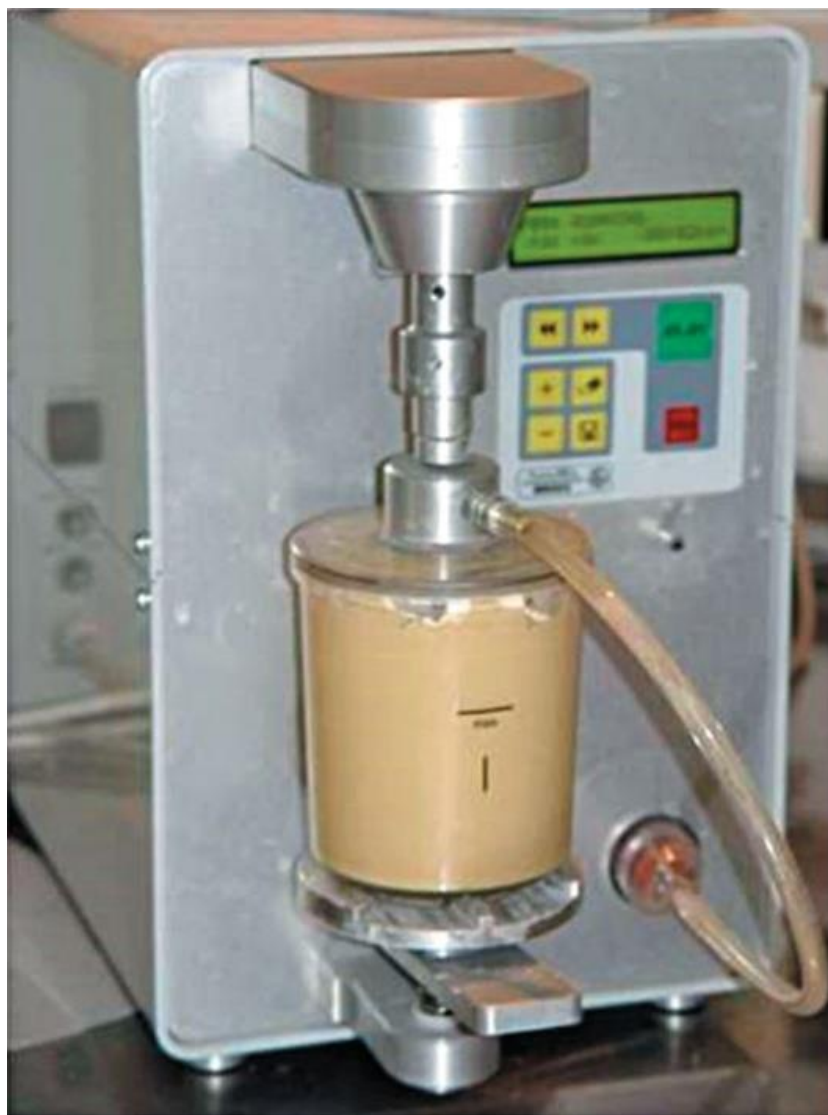
Рис. 2.89. Замешивание огнеупорной массы в вакуумном смесителе
