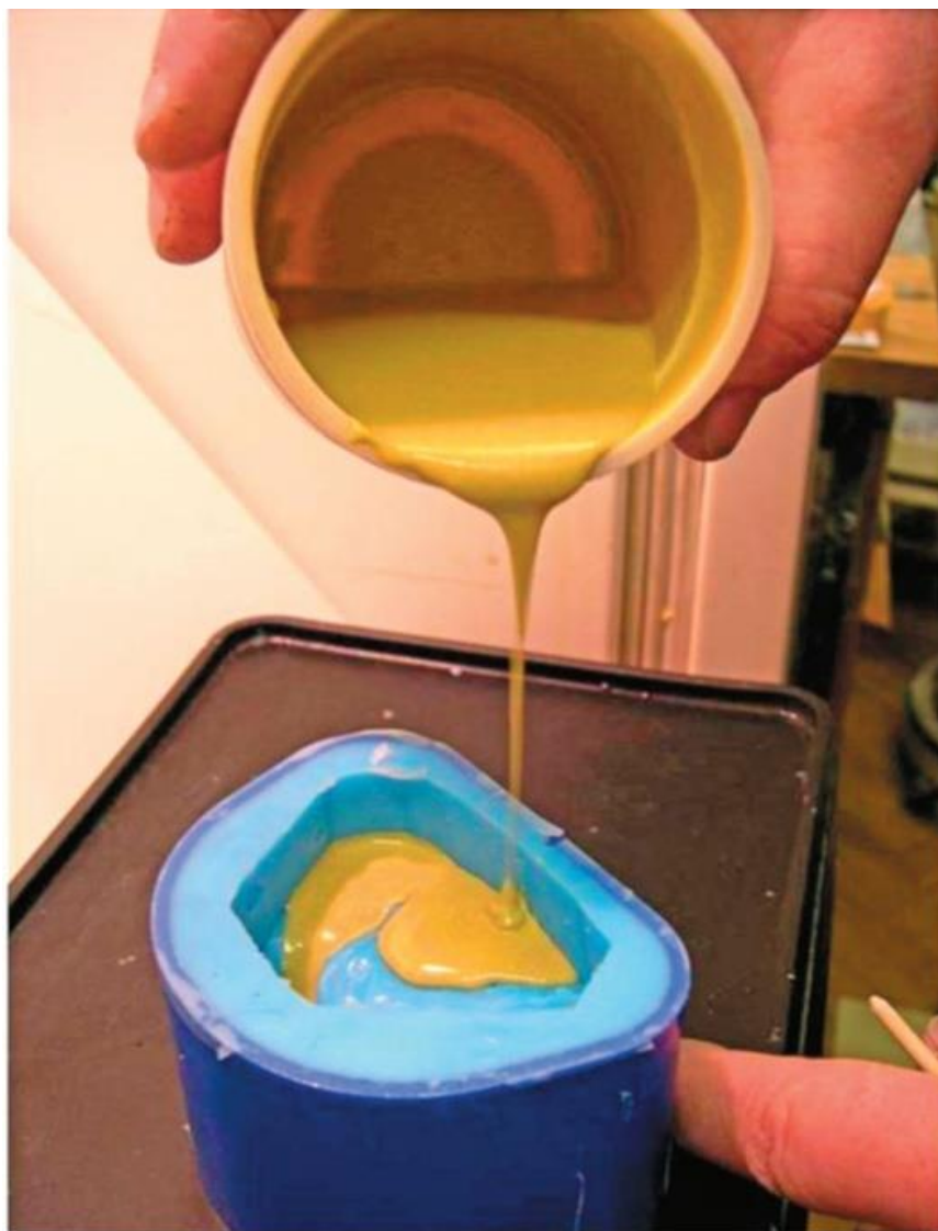
Рис. 2.84. Заливка огнеупорной массы в силиконовую форму
